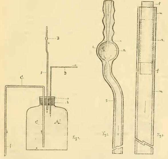
des Wassers und treibt dieses durch die Röhre C hinaus (Fig. 1). Diese besitzt eine Weite von 10—12 mm, reicht bis zum Flaschen-boden, durchsetzt luftdicht den Pfropfen und biegt dann rechtwinklig ab, um sich in der beliebig langen Abflußröhre f fortzusetzen. Diese muß mit der Steigröhre C einen Heber bilden, da der Luftdruck in der Flasche nicht genügt, den Widerstand einer langen Leitung
